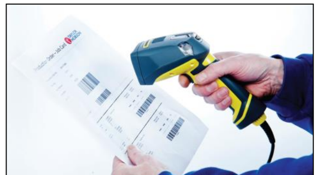
Obrázek 2 - Metrology 4.0 byl vytvořen pro výrobní prostředí. Čtečky čárových kódů rychle a efektivně identifikují vzorky a automatizují proces kontroly.
