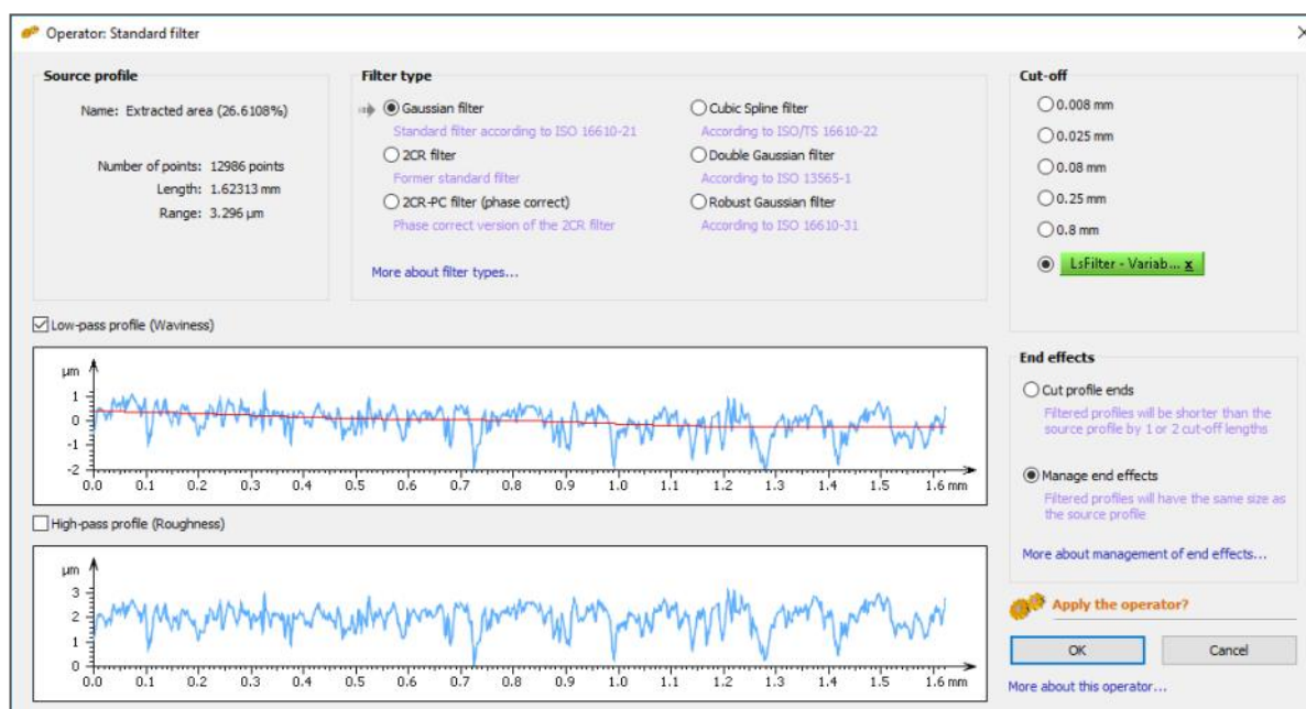
Obrázek 9 - v tomto příkladu je proměnná „LsFilter“ použita místo numerické hodnoty v operátoru „Standardní filtr“
