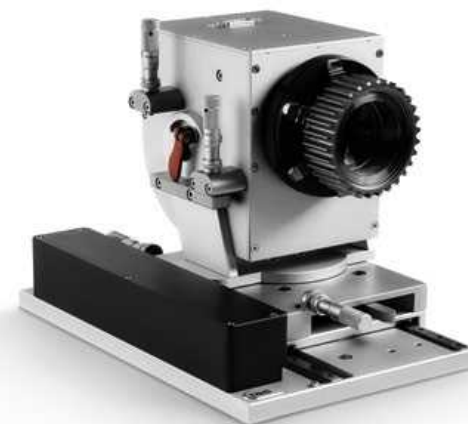
ConturoMatic Rotační jednotka RS1- příklad axiálního směru měření 90°
