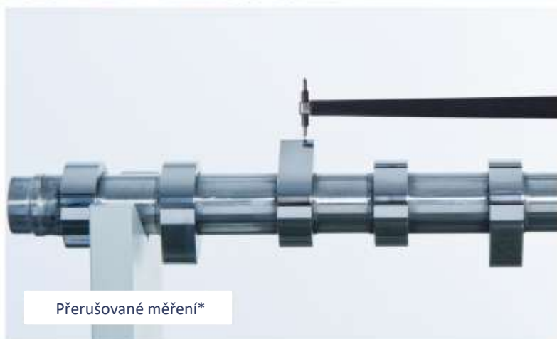
Snadný přístup do děr s 200 mm raménkem
